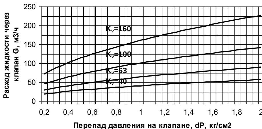
График подбора клапанов КСР Ду 80, 100
