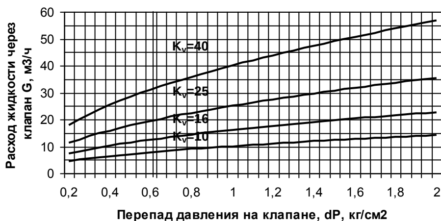
График подбора клапанов КСР Ду 32, 50
